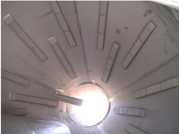
Auflockerungsstreifen aus porösem Sinteredelstahl.
