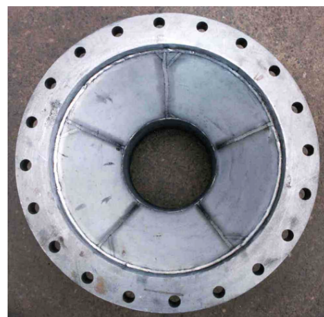
Konus mit Auflockerungseinrichtung aus porösem Sinteredelstahl für Glasfritten.
