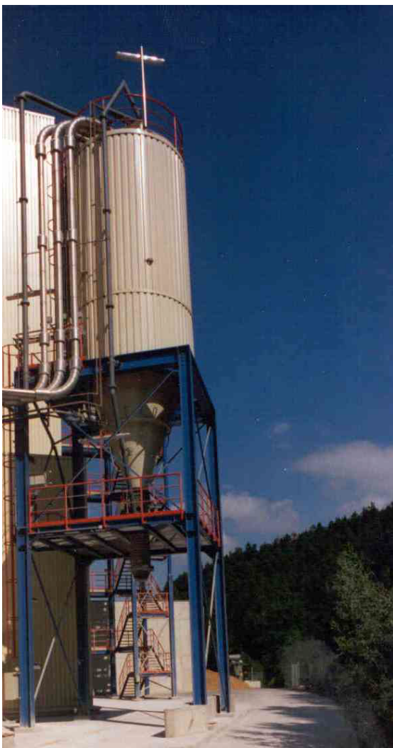
Reststoffsilo mit Beladegarnitur. D - Marsberg-Giershagen.
